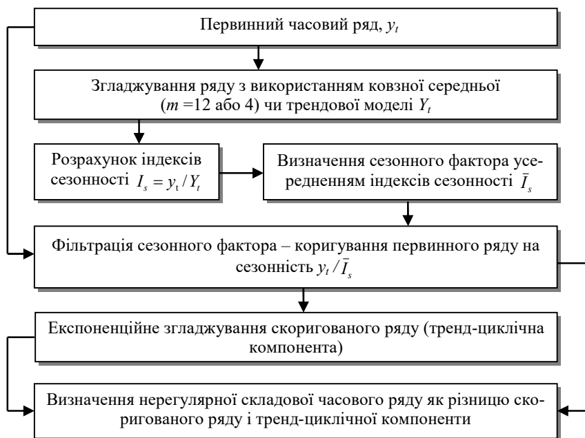
Рис. 5.2. Етапи сезонної декомпозиції часового ряду (адитивно-мультиплікативна модель)
